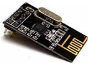
Fig.3. NR24L01 Pulse Wi fi Module
