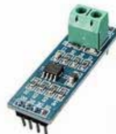
Fig. 6. MAX485 Modbus Module
